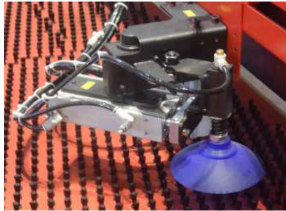
图 3-4 板料定位于冲床夹钳装置示意图
